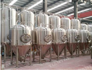
**Gär- und Lagertanks** in unterschiedlichster Grösse und Ausführung. In Edelstahl gefertigt (bereits ab 50lt bis 5'000lt Volumen).
