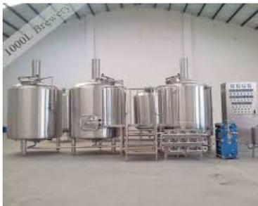
Maische-, Läuterbottich, Whirlpool und Heisswassertank mit unterschiedlicher Aufstellung, Anordnung für den Brauprozess individuell-optimal konzipiert.
