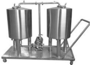
Kompakte fahrbare CIP Reinigungswagen, mit Heizung für Laugebehälter
