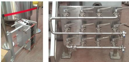
Leistungsfähige Plattenkühler (1- oder 2 Stufen), zur Reinigung einfach demontierbar
