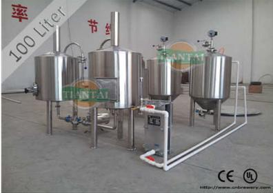
**Komplette Brauerei** für 100lt Ausstoss, Sudhaus (Maischebottich mit Rührwerk) mit Gärtank in Chromstahl gefertigt, komplett mit allem Zubehör wie Pumpe, Verrohrung und Wärmetauscher, etc.
